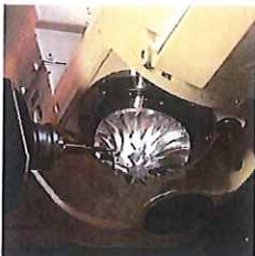
付加2軸傾斜インデックステーブルを使用した3次元輪郭加工 ワーク: アルミミニウム合金
