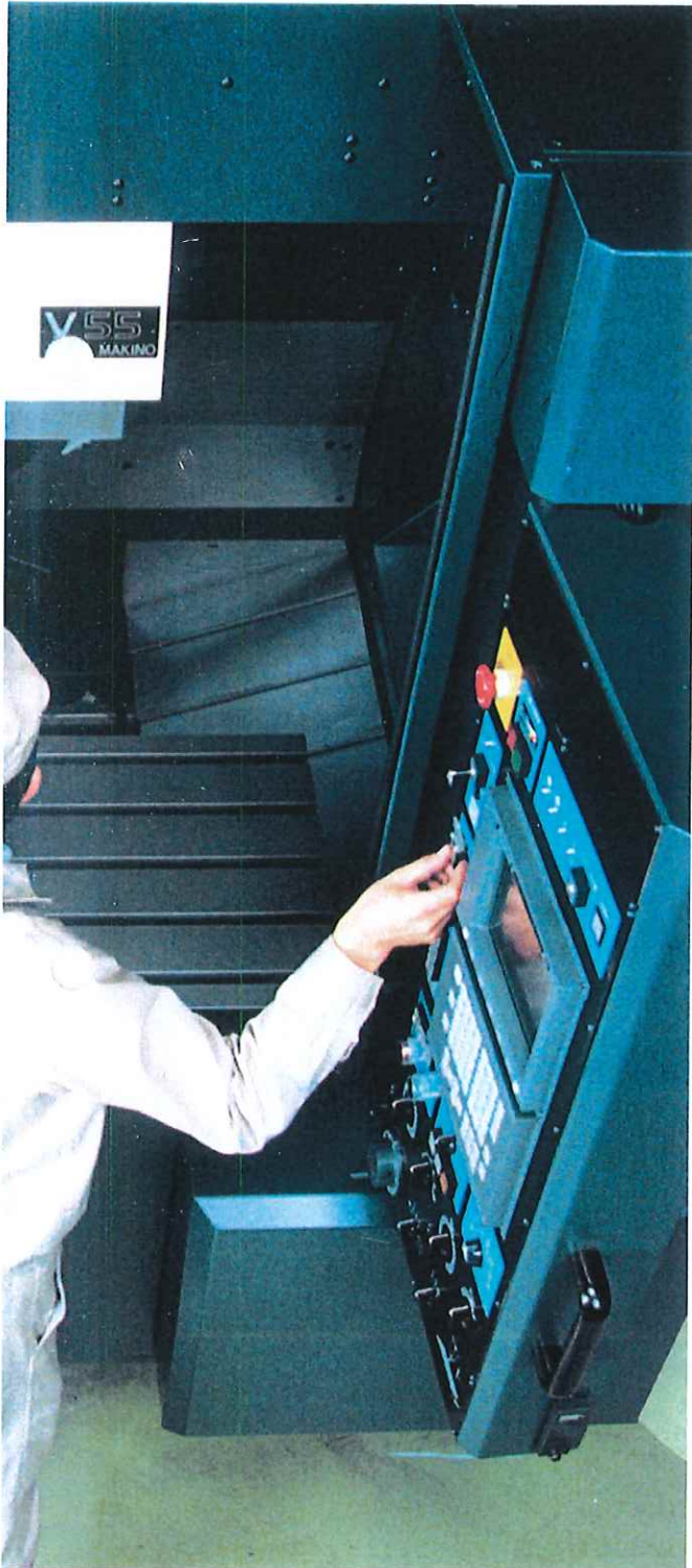
スウィングタイプ操作盤 (0° ~ 90°)
